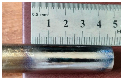
Рисунок 11 – Фото коллектора после обработки с использованием секционированного полого анода. Параметры: p = 4 \times 10^{-2} Па, I_0 = 20 А, t = 100 мкс, U_0 = 30 кВ, E_{уд} = 2,5 Дж/см 2 , N = 100 имп., ширина эмиссионной области 5 см
