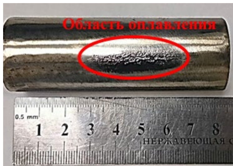
Рисунок 4.7 – Фото коллектора после обработки. Параметры: p = 4 \times 10^{-2} Па, I_0 = 20 А, t = 100 мкс, ширина эмиссионной области 5 см
