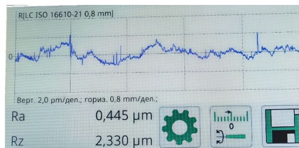
Рисунок 4.22 – Результаты профилометрии поверхности образца из стали марки 12X18H10T: a – без обработки электронным пучком, б – после обработки
