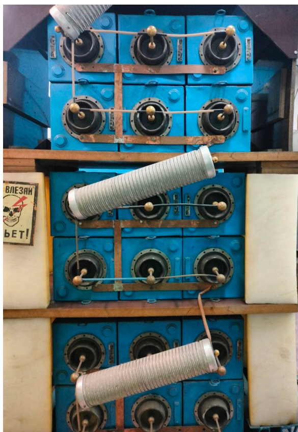
Рисунок 2.5 – Высоковольтная система электропитания: а – высоковольтная конденсаторная батарея, б – каскадный генератор
