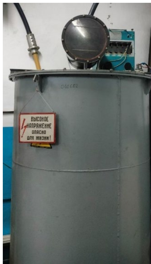
Рисунок 2.5 – Высоковольтная система электропитания: а – высоковольтная конденсаторная батарея, б – каскадный генератор
