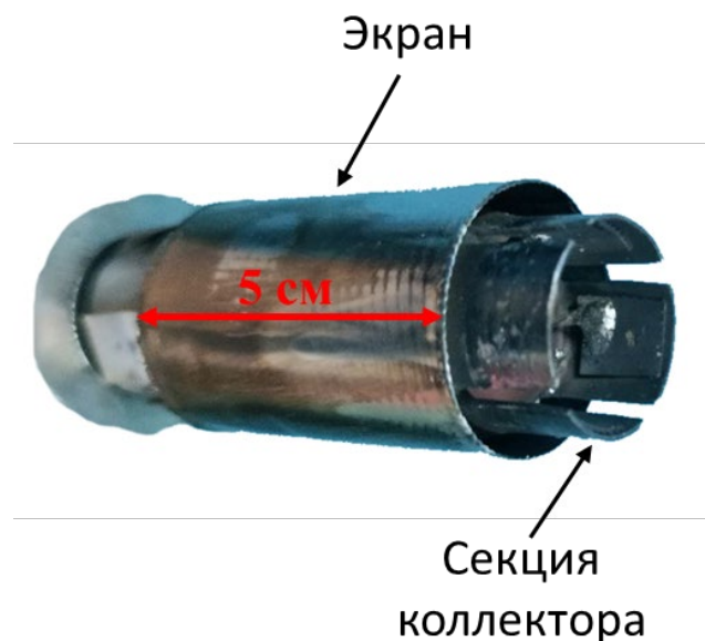
Рисунок 2.11 – Секционированный коллектор для радиально сходящегося электронного пучка
