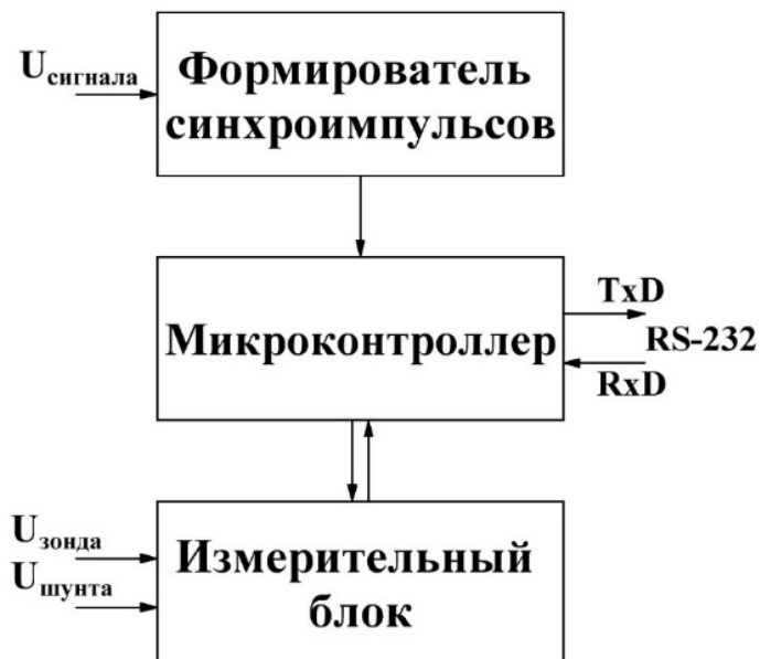
Рисунок 2.8 – Блок-схема зондовой системы измерения параметров плазмы
