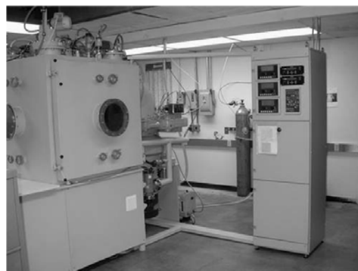
Рис. 21. Установка для нанесения твердых а-С и а-С:Н покрытий.
