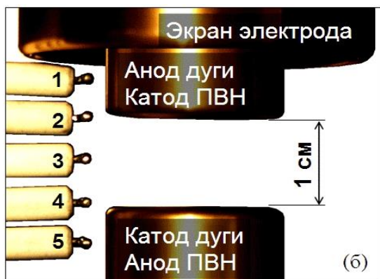
Рисунок 2 – Разрядный промежуток с набором из 5 одиночных цилиндрических зондов Ленгмюра.
