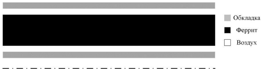
Рисунок 7.2. Схема структуры цилиндрического конденсатора с воздушными зазорами между ферритом и обкладками.
