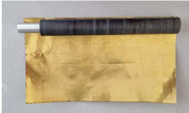
Рисунок 7.1. Внешний вид сборки цилиндрического конденсатора с ферритовыми кольцами.
