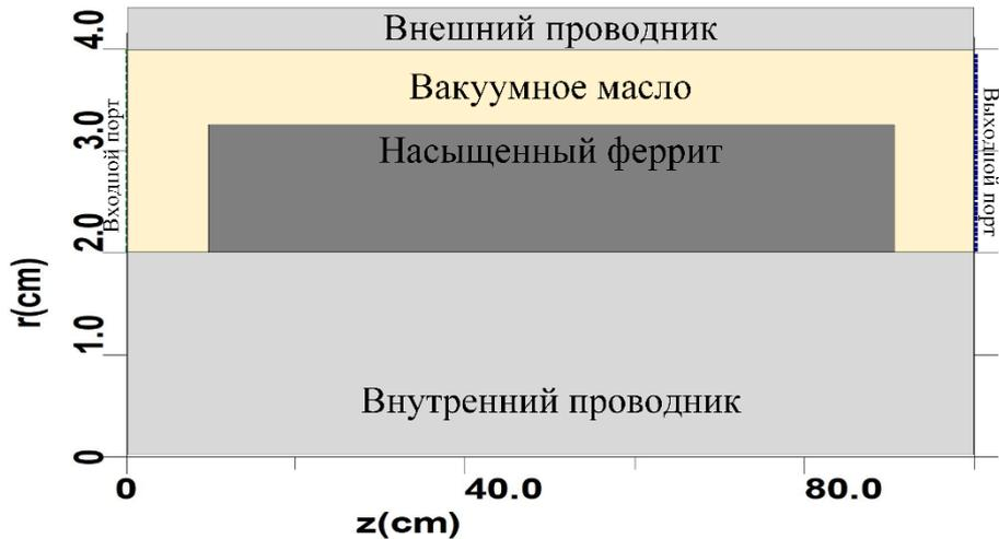
Рисунок 2.1. Схема расчётной области НПЛ из в RZ версии.
