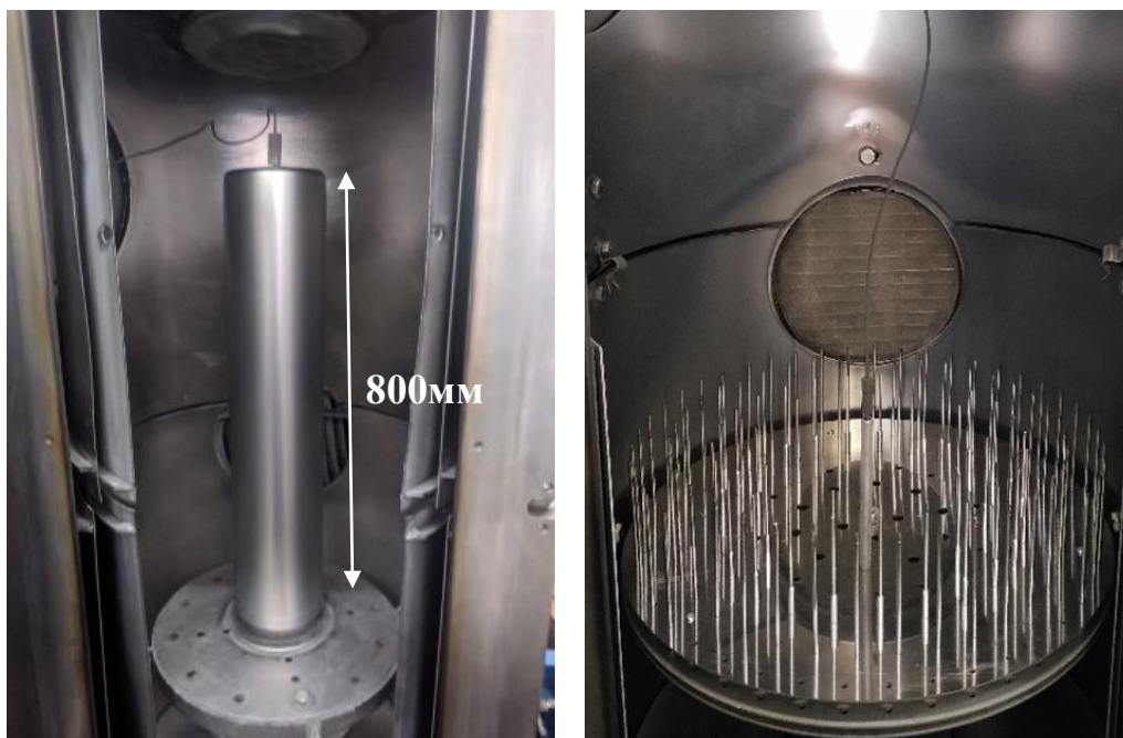
Рисунок 10 – Азотированные пуансоны из штамповых сталей в рабочей камере установки для генерации пучково-плазменных образований в несамостоятельном тлеющем разряде низкого давления с полым катодом
