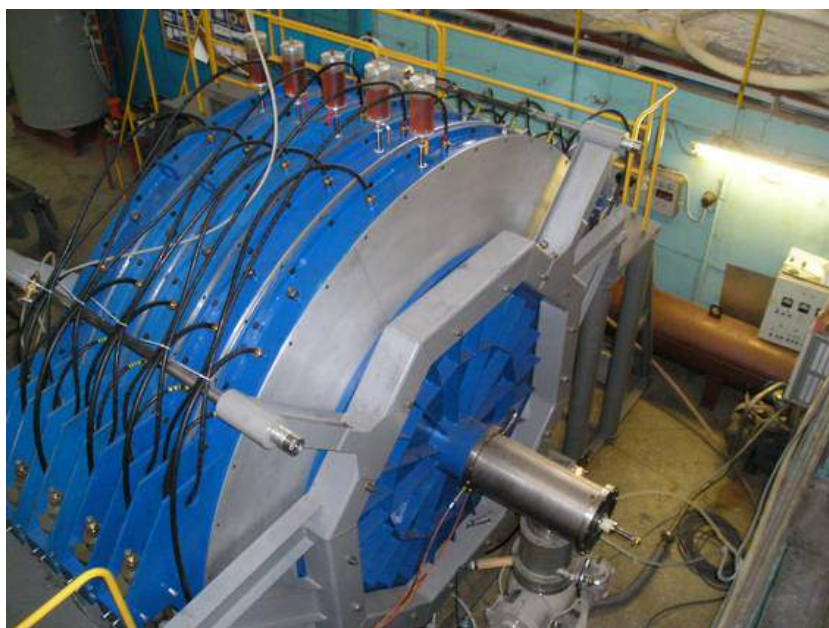
Рисунок 1.21 – Модуль из пяти 1 МА ЛТД ступеней с масляной изоляцией
