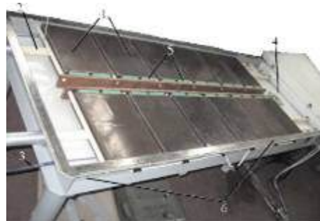
Рисунок 7.1 – Субмикросекундный генератор тока: 1– секции; 2– высоковольтный ввод зарядного напряжения; 3– пусковой проводник; 4– область нагрузки; 5– демпфирующие резисторы; 6– корпус генератора
