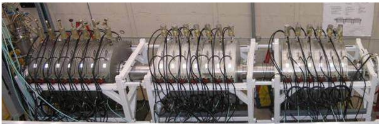
Рисунок 1.20 – Ускоритель URSA Minor в составе 21-ой ЛТД ступени с проектным выходным напряжением 2.5 МВ на электронном диоде с сопротивлением 50 Ом [96]
