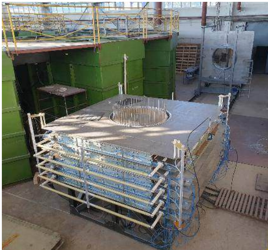
Рисунок 6.25 – Модуль в составе пяти ЛТД ступеней с горизонтальным расположением в ходе испытаний
