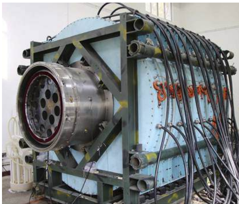
Рисунок 1.22 – Модуль М-50-1 (Китай) из 10 ЛТД ступеней с мегаамперным уровнем тока
