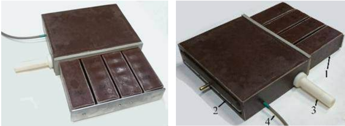
Рисунок 7.15 – Секция с емкостью накопителя 3.2 нФ: 1 – конденсаторы К15-10, залитые компаундом; 2 – шестизазорный семиканальный искровой разрядник; 3 – высоковольтный ввод зарядного напряжения; 4 – пусковой проводник
