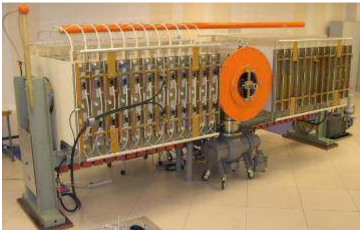
Рисунок 5.2 – Фотографии ЛТД генератора в составе двух модулей из двенадцати ступеней (слева) и XeF(C-A) усилитель мультитераваттной фемтосекундной лазерной системы THL-100 в сборе (справа)
