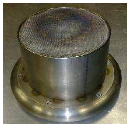
Рисунок 7.11 – Конструкция диода и фотография катода. А– анод; С– катод
