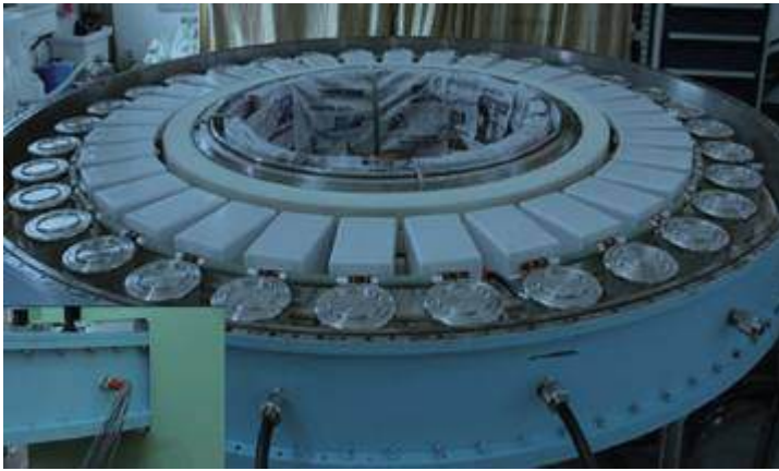
Рисунок 1.15 – Слева: ступень с 32 секциями для модуля М-50 мультимегамперной ЛТД установки (Китай). Справа: осциллограмма тока ступени на согласованной нагрузке 0.09 Ом [76]
