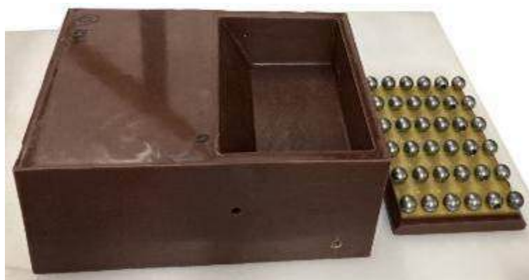
Рисунок 3.4 – Фотография секции 160 нФ с извлеченным разрядником
