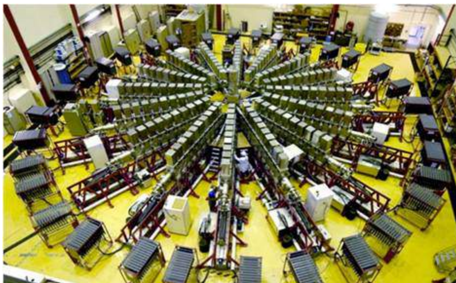
Рисунок 1.16 – Микросекундная ЛТД установка SPHINX в Исследовательском Центре Грама, Франция
