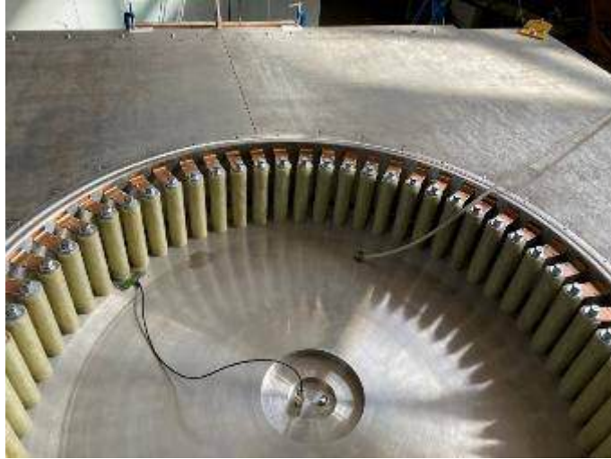
Рисунок 6.9 – Нагрузка для испытаний и исследования характеристик ЛТД ступени
