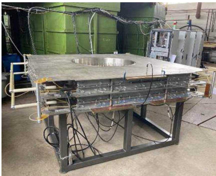
Рисунок 6.22 – Модуль в составе двух ЛТД ступеней в горизонтальном положении
