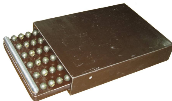
Рисунок 4 – Конструкция и фотография секции с емкостью накопителя 80 нФ: 1– корпус; 2– конденсаторы; 3– разрядник
