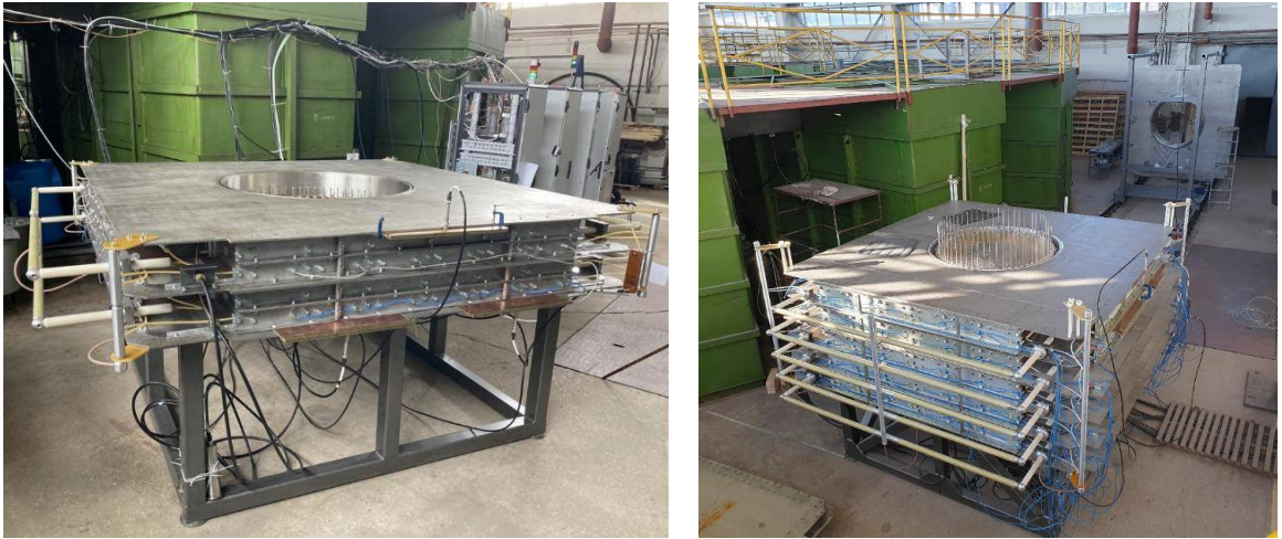
Рисунок 15 – Модуль в составе двух (слева) и пяти (справа) ЛТД ступеней в горизонтальном положении
