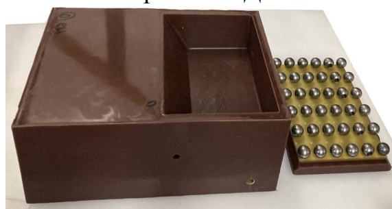
Рисунок 3 – Конструкция и фотография секции с емкостью накопителя 160 нФ: 1– конденсаторы; 2– корпус секции; 3– разрядник
