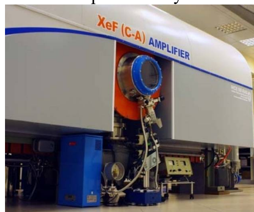
Рисунок 9 – Фотографии ЛТД генератора в составе двух модулей из двенадцати ступеней (слева) и XeF(C-A) усилителя мультитераваттной фемтосекундной лазерной системы THL-100 в сборе (справа)
