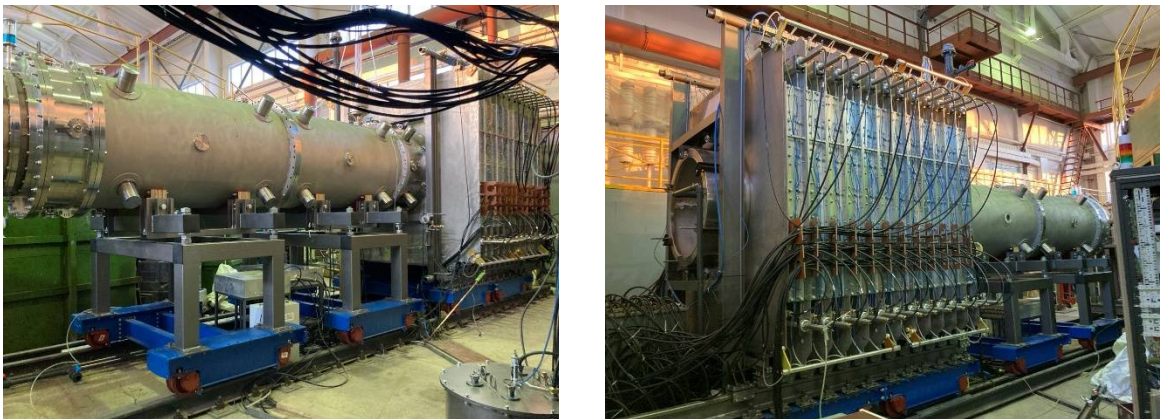
Рисунок 18 – Модуль в составе двенадцати ЛТД ступеней с передающей линией
