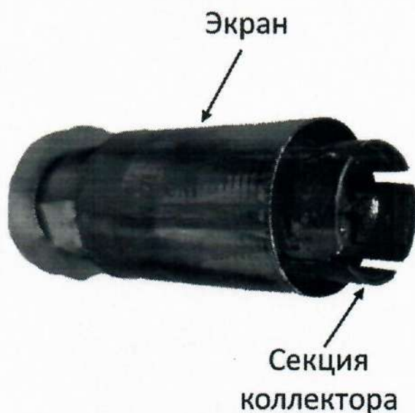
Рисунок 13 – Секционированный коллектор
