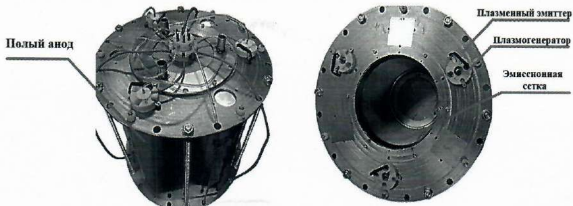
Рисунок 3 – Внешний вид плазменного эмиттера
