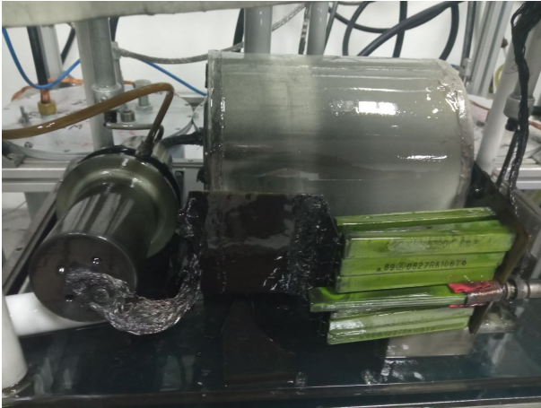
Рис. 5. Фотография конденсатора HSEI CAP 100-0.07, разрядника и резистивной нагрузки после окончания ресурсных испытаний (55 545 импульсов).
