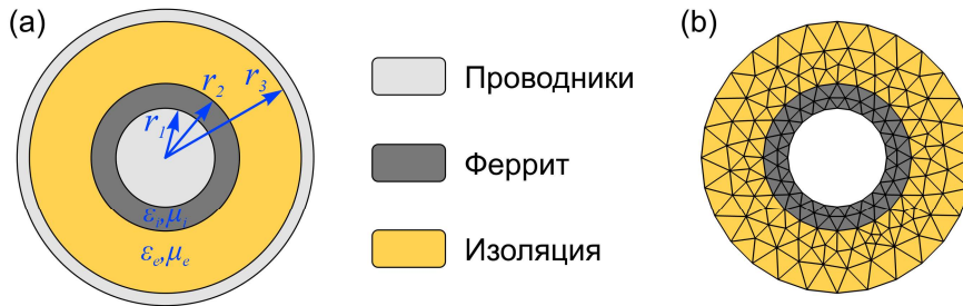
Рис. 1. (а): Поперечное сечение мощной коаксиальной линии с ферритом; (б): Пример расчётной сетки для численного анализа дисперсионных характеристик распространяющихся волн в линии.
