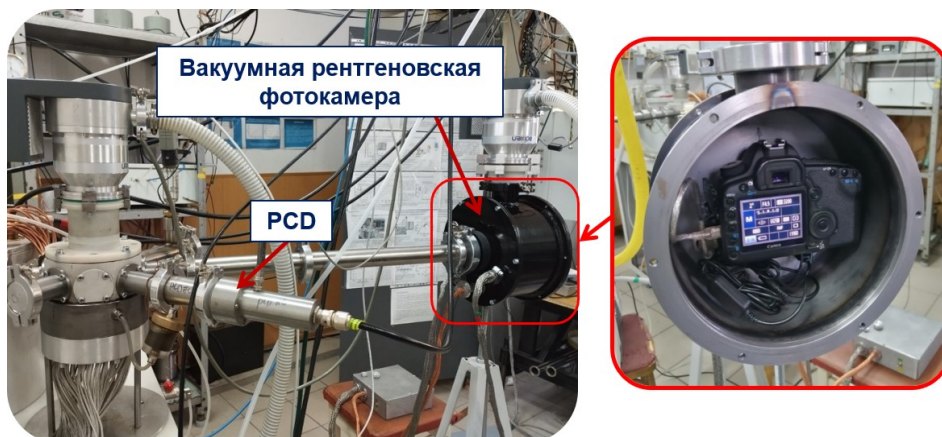
Рис. 3. Внешний вид и расположение вакуумной камеры с цифровым фотоаппаратом и детектора рентгеновского излучения.
