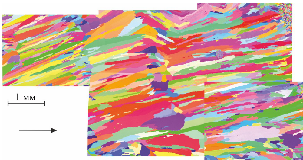
Рис. 1. EBSD-карта типичной структуры образцов, напечатанных методом ЭЛАП на подложках из титана и никелида титана. Направление печати слоев указано стрелкой.
