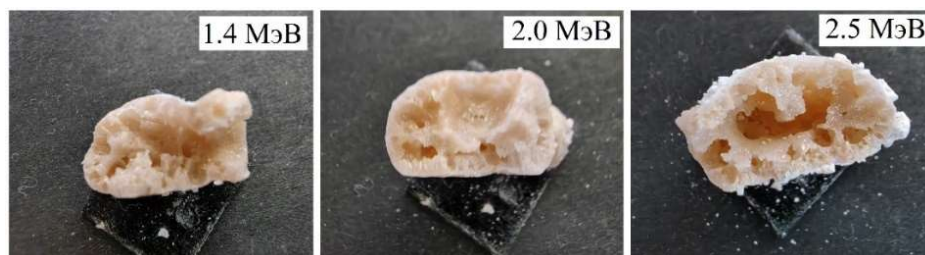
Рис. 2. Оптические изображения поперечных срезов капель синтезированной ВЭК ( Y_{0.2}Yb_{0.2}Lu_{0.2}Eu_{0.2}Er_{0.2} ) 3Al_5O_{12} при разных величинах ускоряющего напряжения.
