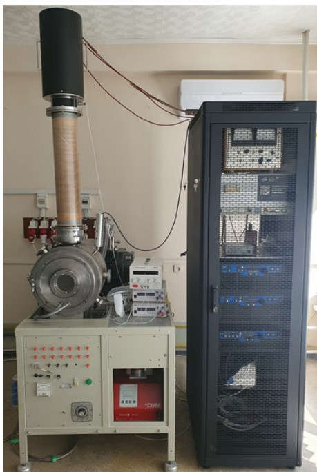
Рис. 1. Фотография экспериментальной установки для электронно-лучевого испарения YSZ керамики и изучения масс-зарядового ионного состава плазмы в форвакууме. Масс-спектрометр RGA-300 крепится к правому боковому фланцу вакуумной камеры и на фотографии не показан, так как удален на профилактическое обслуживание.
