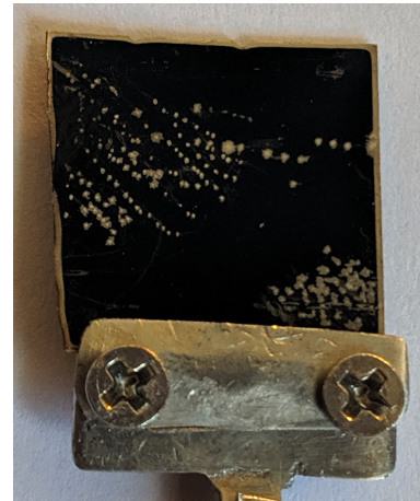
Рис. 2. Фотография поверхности катода, покрытого FUZZ со следами эрозии.
