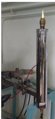
Рис. 4. Действующий макет цельнометаллического плазматрона.
