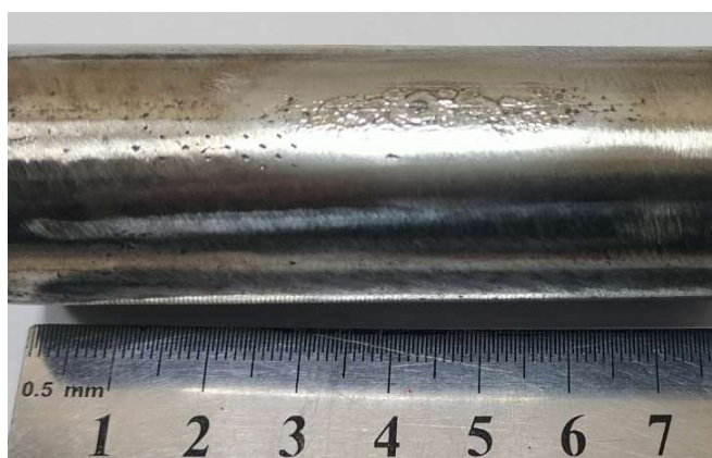
Рис. 5. Фотография коллектора из нержавеющей стали в режиме облучения: ускоряющее напряжение 50 кВ, длительность облучения 10 мин., частота импульсов 1 Гц, ток I_0 = 35 А, длительности импульса 150 мкс, давление – 4 \cdot 10^{-2} Па.
